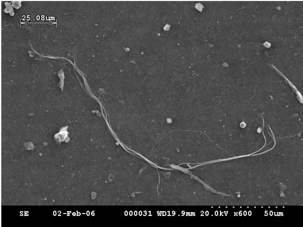
**Fotografía 2.2** Microfotografía de fibras de amianto crisótilo tomada con un microscopio electrónico de barrido.
