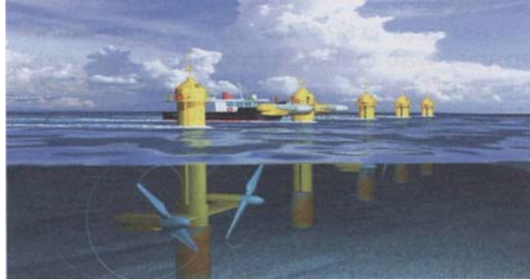
Figura A1.24. Sistemas seaflow: aprovechamientos de las mareas bajo el agua
