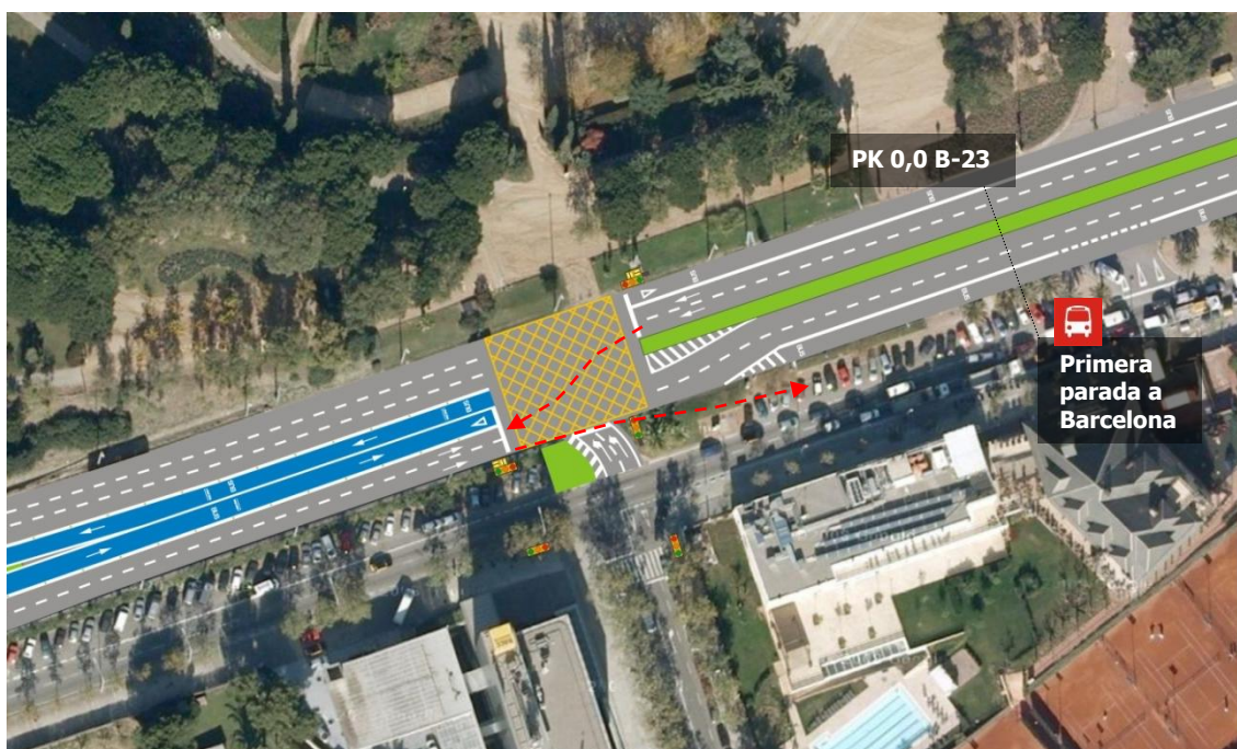
Proposta de transició de carril bus central a carril bus lateral a la cruïlla de la B-23 amb Albert Bastardes
